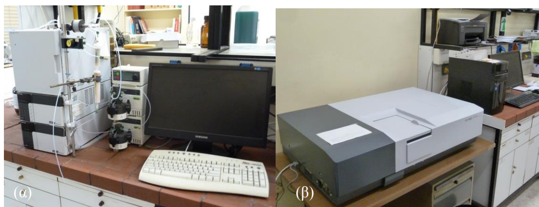
Εικόνα 14. Εργαστήριο Οργανικής Χημείας, (α) Σύστημα MPLC Buchi, (β) UV-Vis-NIR Shimadzu 3600
